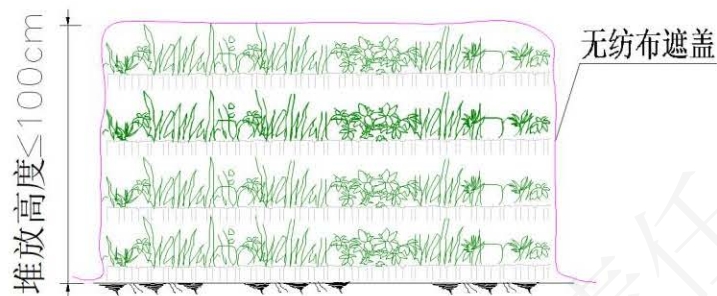
图 4.3-2 草皮堆放断面示意图
