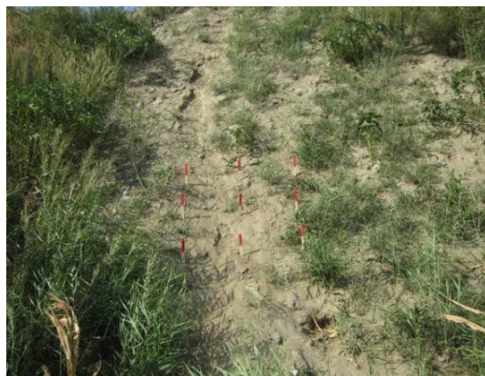
图 6 野坝表土暂存场边坡简易水土流失场
