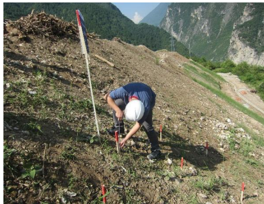
图 4 汤坝土料场现场简易水土流失场观测场测量
